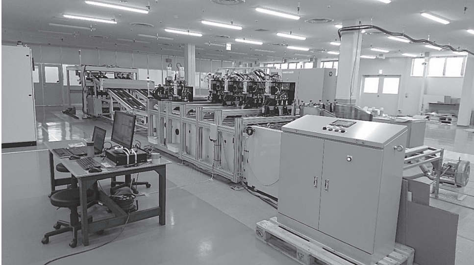
(IJH-CL ロボットを搭載したライン型フルカラーデジタルオンデマンド印刷システム。写真は同社提供)
